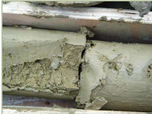
Los ensayos realizados al corte sin drenaje (Vane test) efectuados sobre estas arcillas/limos aluviales, presentan valores comprendidos entre 0.35 y 0.75 Kg/cm<sup>2</sup>. Mediante penetrómetro, se han obtenido generalmente, valores de resistencia a compresión simple comprendidos entre 1.00 y 2.50 Kg/cm<sup>2</sup>.
